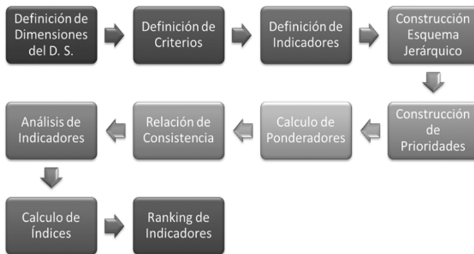
Ilustración 1. Metodología de análisis multicriterio aplicada al proyecto MDL de generación de energía eléctrica, a partir de los residuos de caña de azúcar por parte de Incauca S.A.
