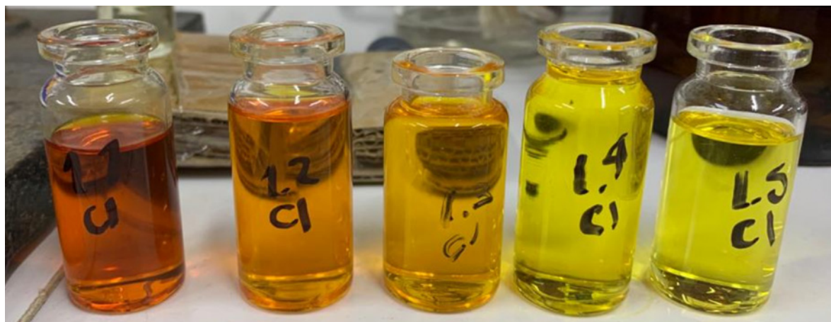
Figura 3. Fracciones obtenidas por medio de cromatografía de columna. Fracciones concentradas recolectadas en viales, con cloroformo como solvente
