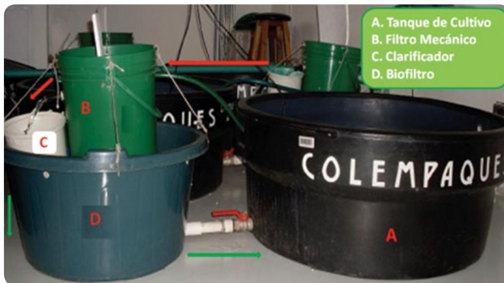
**Figura 1.** SCR empleado para el levante de *P. pictus*. Las flechas rojas indican el flujo de agua de entrada al biofiltro y las verdes el flujo de agua de salida al tanque de cultivo (Modificado de Timmons et al., 2007; Carrascal, 2010; Hernández et al, 2010).
