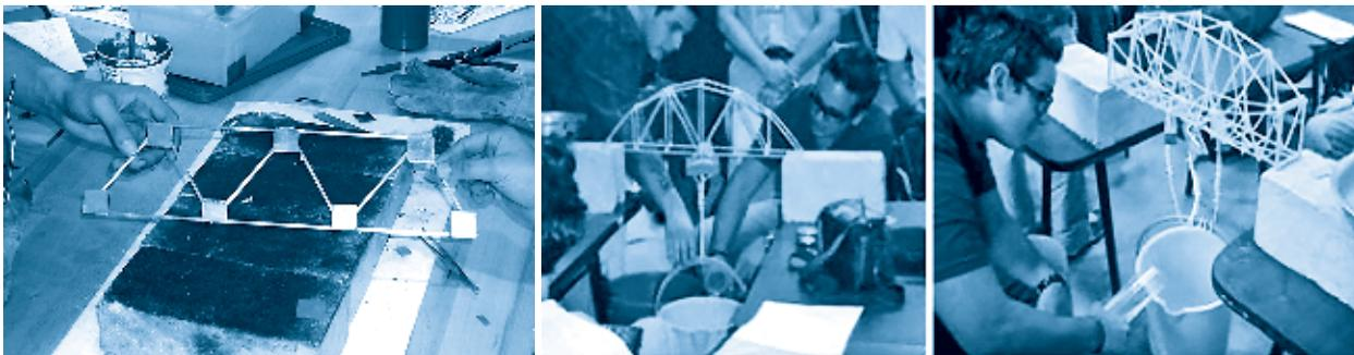
**Figura 6.** a) Estructura construida en cobre por estudiantes (Hadim et al., 2000) b) Pruebas de estructuras realizadas con pasta comestible construidas por estudiantes (Ruiz et al., 2006)
