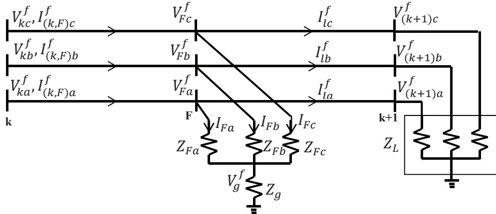
**Figura 4.** Modelo equivalente de una falla trifásica en un alimentador de distribución
