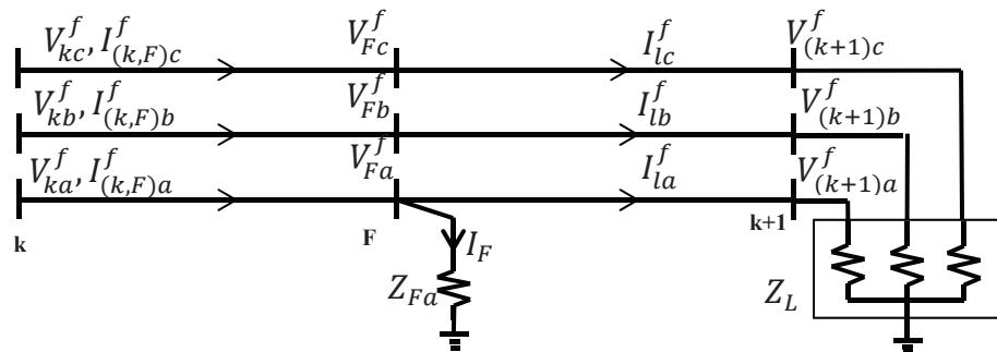
**Figura 2.** Modelo equivalente de una falla monofásica.
