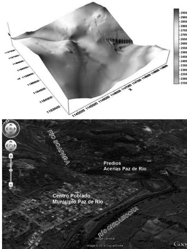
**Figura 12.** Superficies topográficas comparadas; parte superior, superficie aproximada generada a través de las curvas de nivel cada 10 metros; parte inferior, captura real de la zona de estudio.
