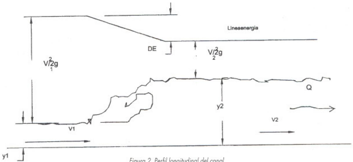
Figura 2. Perfil longitudinal del canal
