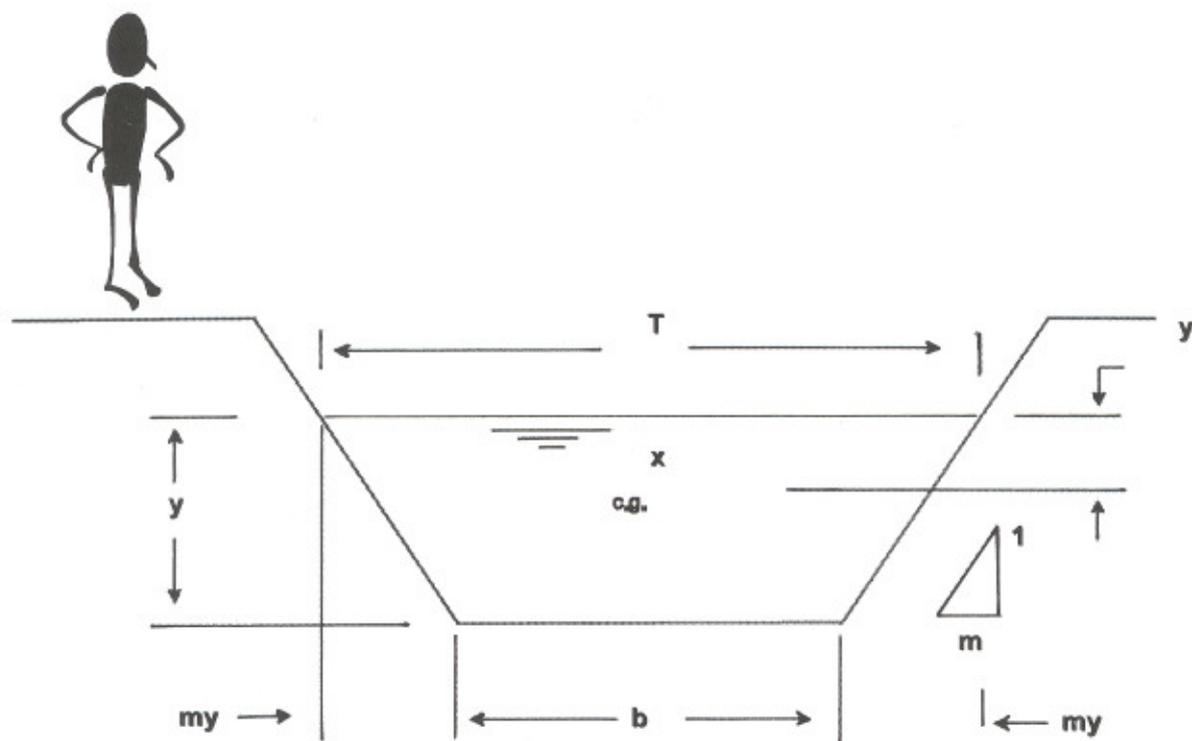
Figura 1. Sección típica del Canal
