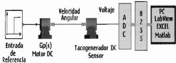
Figura 14. Esquema de sistema de motor DC
