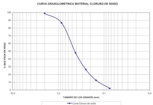
Figura 3. Curva granulométrica del Cloruro de Sodio
