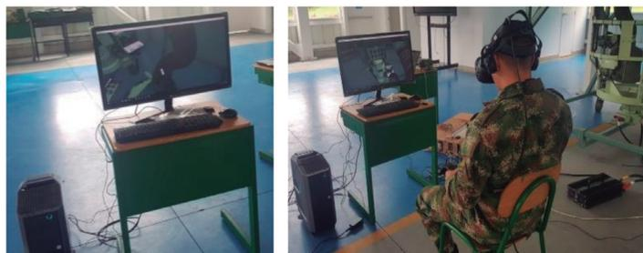
**Figura 3.** Sistema demo de realidad virtual de la torreta Asv 40/50 en funcionamiento durante los experimentos de prueba.
