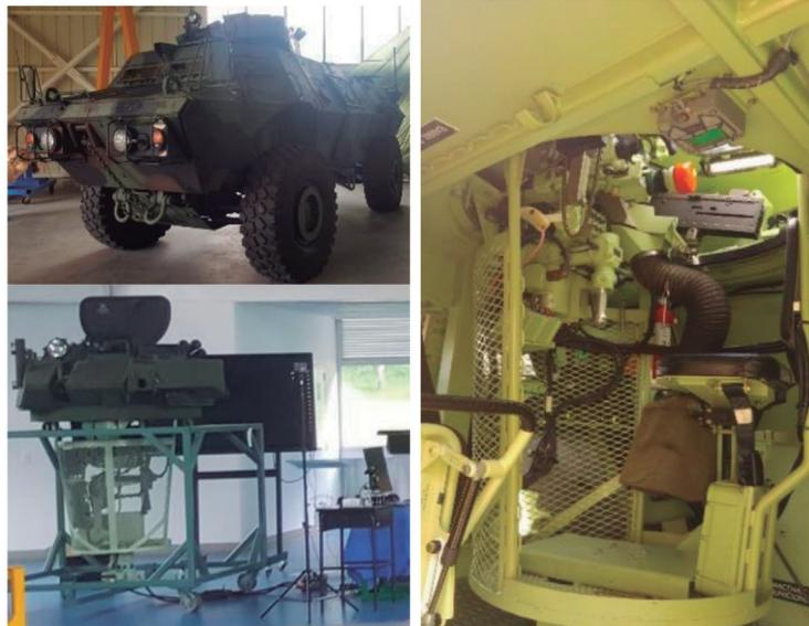
**Figura 2.** Imágenes de la torreta 40/50 del ASV de entrenamiento en el centro de simulación del ESCAB.
