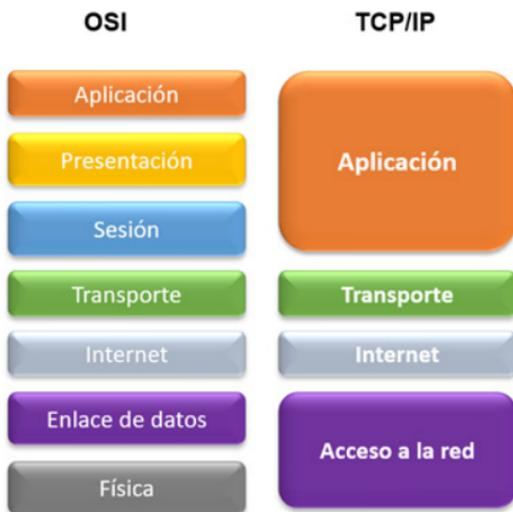
**Figura 1.** Comparación de capas entre el modelo OSI (Open System Interconnection) y el modelo TCP/IP (Transmission Control Protocol/Internet protocol).
